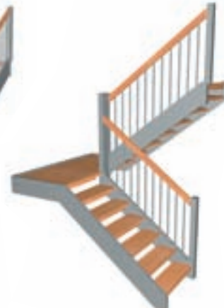
U-Treppe mit Podest
