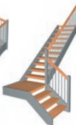
L-Treppe mit Podest
